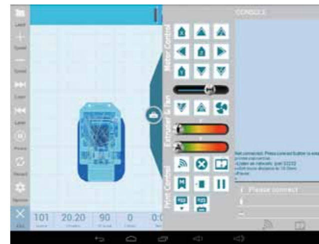
Der linke Teil der Android-App dient der allgemeinen Steuerung, wohingegen die Maschinensteuerung und das Aufheizen des Extruders oder des Drucktisches sowie die Verbindung zwischen Tablet und Maschine über die einklappbare rechte Bildschirmhälfte erfolgt
