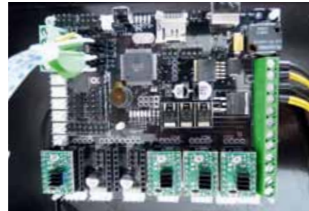
Die Steuerplatine mit einem Atmega 2560-Prozessor verfügt über genügend Leistung zum Ansteuern der drei Achsen und des Extruders
