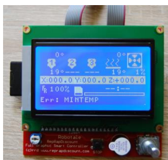
Bild 4: Die SD-Kartenlösung ist in verschiedenen Varianten erhältlich, zum Beispiel auch als „Full Graphic Smart Controller“, einer Lösung mit allen Komponenten auf einer Platine.
