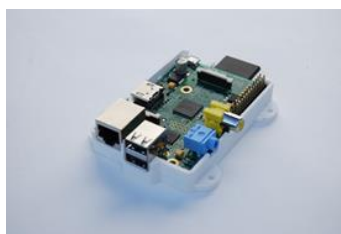
Bild 6: Der Mini Rechner Raspberry Pi (Model B)
