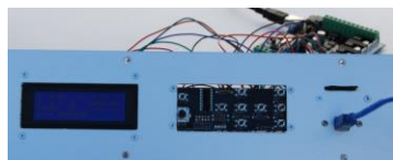
Bild 3: Einbau in eine Frontplatte mit Display, Keypad, SD-Kartenfassung und USB-Kabel .
