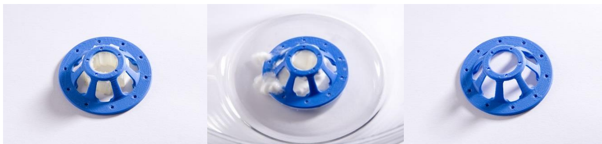
Abbildung 6: Links: Bauteil mit PVA-Stützstruktur; Mitte: Stützstruktur wird im Wasserbad gelöst; Rechts: fertiges Bauteil
