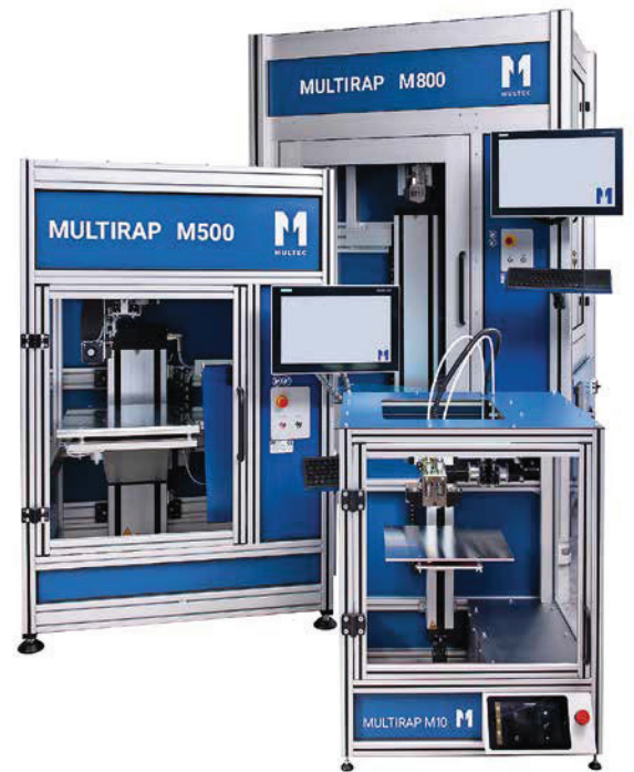
3 Größen umfasst derzeit das Multec-Multirap-Industriedruckerprogramm. Die Drucker lassen sich sogar mit Neuentwicklungen nachrüsten, um so die Drucker immer auf dem neuesten technischen Stand zu halten. Bild: Multec
